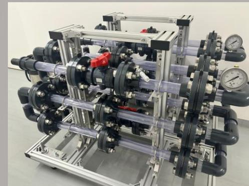
ファインバブルCO<sub>2</sub>回収装置
